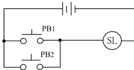
28. (2) 如下圖所示，為按鈕開關控制指示燈電路，兩個按鈕開關 PB1、PB2 控制指示燈 SL 亮熄，「押下」表示按鈕開關押下，「放開」表示按鈕開關放開，則 ①PB1 放開、PB2 放開時，SL 熄 ②PB1 放開、PB2 押下時，SL 熄 ③PB1 押下、PB2 放開時，SL 亮 ④PB1 押下、PB2 押下時，SL 亮。
