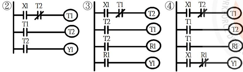
16. (3) 如下方時序圖所示，下列何者為正確的 PLC 迴路？
