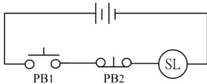
26. (2) 如下圖所示，為按鈕開關控制指示燈電路，兩個按鈕開關 PB1、PB2 控制指示燈 SL，「押下」表示按鈕開關押下，「放開」表示按鈕開關放開，則 ①PB1 放開、PB2 放開時，SL 熄 ②PB1 放開、PB2 押下時，SL 亮 ③PB1 押下、PB2 放開時，SL 熄 ④PB1 押下、PB2 押下時，SL 亮。
