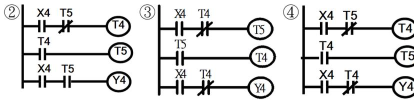
18. (1) 如下方時序圖所示，下列何者為正確的 PLC 迴路？
