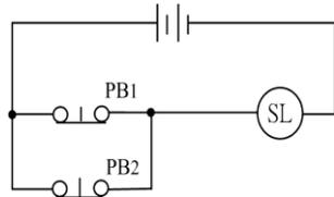
27. (4) 如下圖所示，為按鈕開關控制指示燈電路，兩個按鈕開關 PB1、PB2 控制指示燈 SL，「押下」表示按鈕開關押下，「放開」表示按鈕開關放開，則 ①PB1 放開、PB2 放開時，SL 亮 ②PB1 放開、PB2 押下時，SL 熄 ③PB1 押下、PB2 放開時，SL 熄 ④PB1 押下、PB2 押下時，SL 亮。
